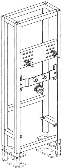
❶ Positionner le lavabo sur le bâti à l'aide de kit de fixation
