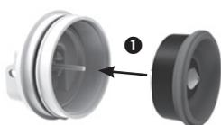
Remonter l'ensemble sur le corps en veillant à aligner l'ergo dans l'encoche.
