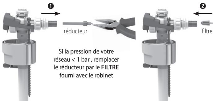
Si vous ne connaissez pas la pression de votre réseau, utiliser le robinet en version standard et tester la durée de remplissage du réservoir. Si elle est anormalement longue (>2min), remplacer le réducteur par un filtre.
