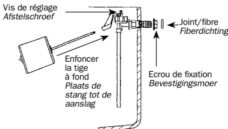
Visser à la main l'écrou du robinet jusqu'au contact de la céramique. Si nécessaire visser d'un quart de tour supplémentaire (maxi) à l'aide de la clé spécifique.
