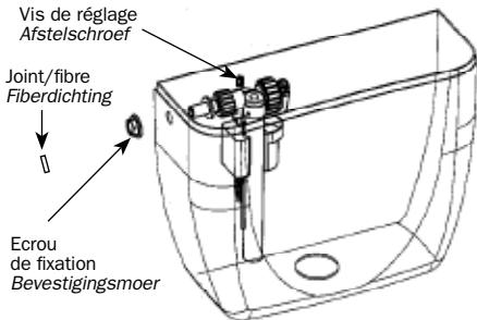
Schroef manueel de moer van het vlotterkraan vast tot ze in contact komt met het keramiek. Indien nodig schroeft u ze (maximaal) een bijkomende kwartslag vast met de speciale sleutel.
