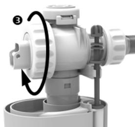
Remplacer le bras E en veillant à placer la fourche autour de la vis de réglage puis le reclipper.
