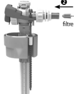
Si vous ne connaissez pas la pression de votre réseau, utiliser le robinet en version standard et tester la durée de remplissage du réservoir. Si elle est anormalement longue (>2min), remplacer le réducteur par un filtre.
