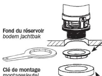
a - Visser à la main l'écrou de bonde (f) Jusqu'au contact de la céramique. Si nécessaire visser d'un quart de tour de supplémentaire (max!) à l'aide de la clé spécifique.
