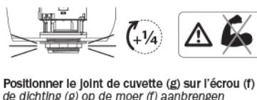
**2 Fixer le réservoir sur la Cuvette**
